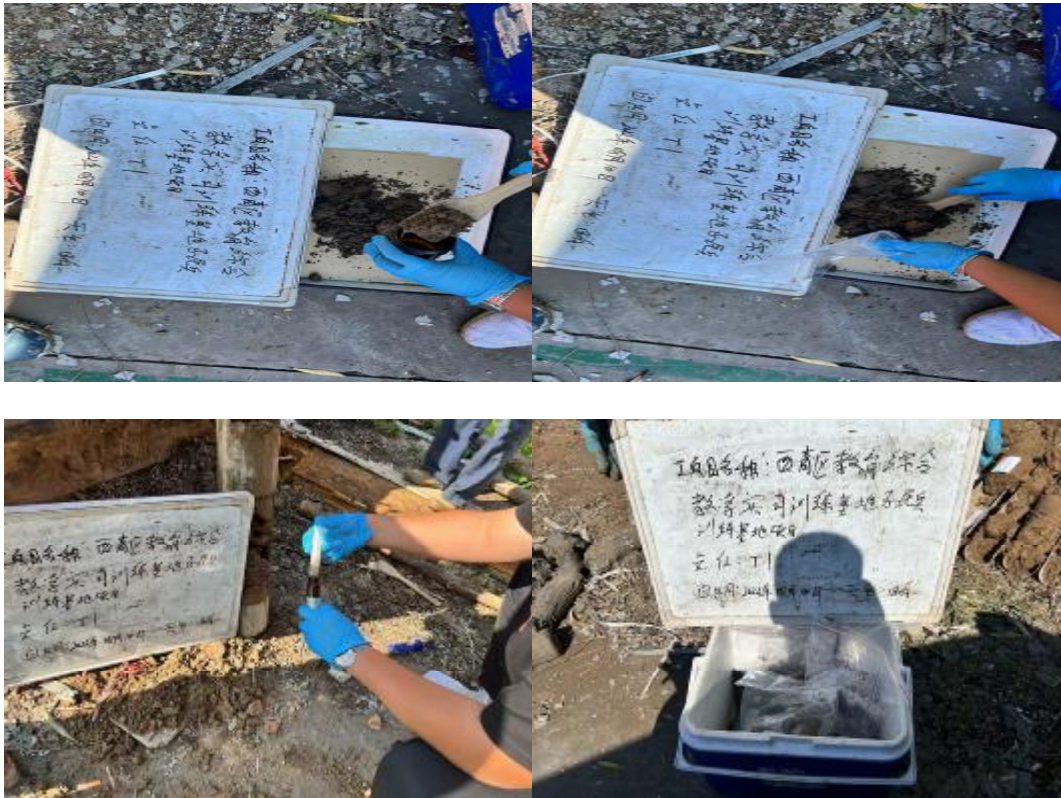
图 4-7 土壤样品现场采集
